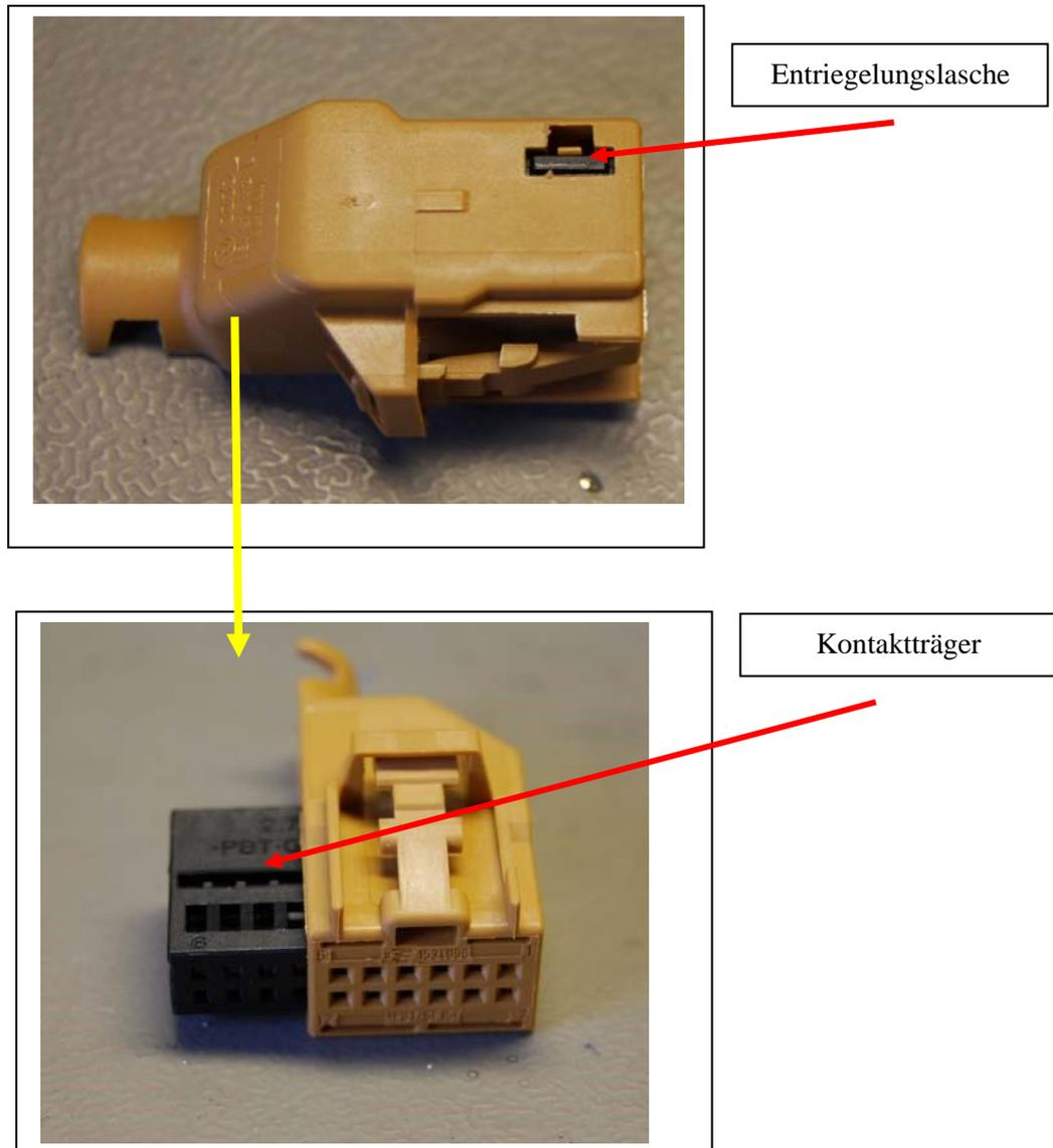
10. Kontakte gemäß unten aufgeführter Anleitung ausspinnen. Dazu mit einem spitzen Werkzeug Rastnase (roter Pfeil) des jeweiligen Kontaktes herunterdrücken und Kontakt aus dem Steckergehäuse herausziehen. (Abb. zeigt nicht den originalen Stecker)
