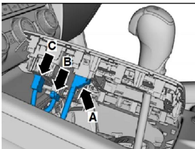
Schaltermodul 1 aus Abdeckung für Schaltbetätigung herausdrücken
